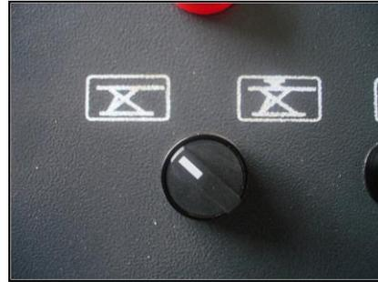
3. 将调试按钮调至调试模式(电源指示灯闪烁), 直到两平台都上升到最高位置时停止。在此过程中, 请注意观察, 如果平台始终不上升, 则电机反转了, 请交换相位。
